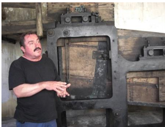
Francisco Moura explicando o funcionamento de um granulador (circuito da pólvora negra) da antiga Fábrica de Pólvora de Vale de Milhaços, extensão do Ecomuseu Municipal do Seixal, Abril 2014 © Graça Filipe
