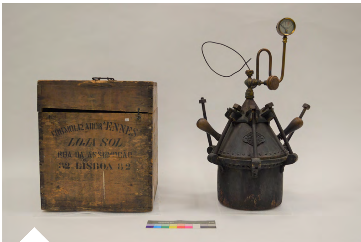
IMAGEM 2. Formolizador Ennes, adquirido na Loja Sol (Lisboa) para o Museu, em 2 de abril de 1913, destinado à desinfeção pelo formol, sob pressão. Museu da Saúde, MS.01576
