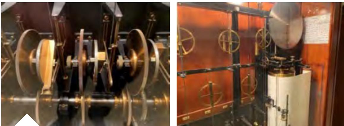
**Figura 2. À esquerda, as rodas dentadas onde se ajusta a amplitude e o desfasamento de cada componente harmónico, calculado pelo histórico de cada porto. À direita, as roldanas e fios que movem a agulha que regista a previsão das marés no papel do tambor rotativo.** © Fotografias do autor.
